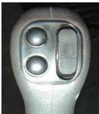
Optionaler Anbaugeräte-Steuerhebel mit dosierbaren Schiebetasten.
