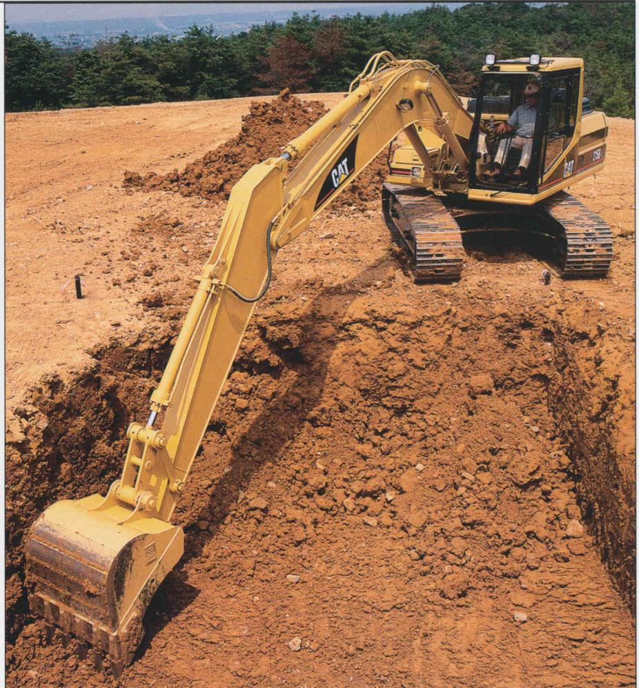
**Le débit de la pompe** diminue quand les commandes sont au point mort, afin de réduire la consommation de carburant et le niveau de bruit.
