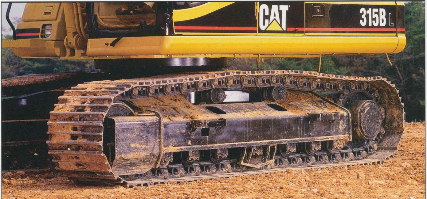
**La précision de la robotique contribue à la qualité des soudures.** Ces dernières augmentent la rigidité, réduisent les contraintes internes et améliorent la durabilité du châssis et des longerons de chaînes.
