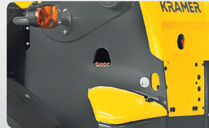
Gemeinsame Schmierstellen: Pendelachse, Hub- und Ausgleichszylinder lassen sich in einem Arbeitsgang schmieren. Das Anheben des Teleskoparms ist nicht nötig.
