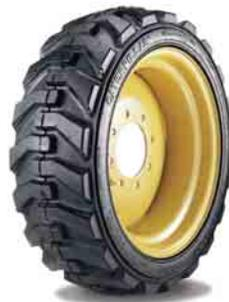
**Cat Reifentyp LSW.** Ein Niederquerschnitts-Reifen mit LSW-Technologie (Low Side Wall), der überragende Pannensicherheit und ausgezeichnete Notlaufeigenschaften bietet. Bestens geeignet für schwere Baustelleneinsätze.
