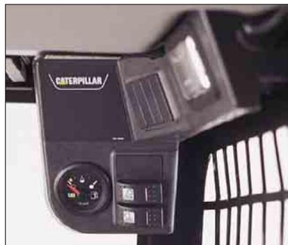
**Rechte Schalttafel.** Die rechte, obere Schalttafel enthält Kraftstoffvorratsanzeige und Innenleuchte sowie Schalter für Arbeitsscheinwerfer und Rundum-Kennleuchte.
