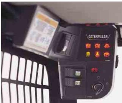
**Linke Schalttafel.** In der linken, oberen Schalttafel sind LED-Kontrollleuchten und Betriebsstundenzähler untergebracht. Abhängig von der Maschinenausrüstung befinden sich hier außerdem die Schalter für Motorstart/-stopp, Feststellbremse, Vorglühanlage, Daueraktivierung (Zusatzhydraulik), Sperrfunktionsübersteuerung (Hydraulik), Parallelführung (Hubeinrichtung) und elektrische Stromversorgung (Zusatzgeräte).
