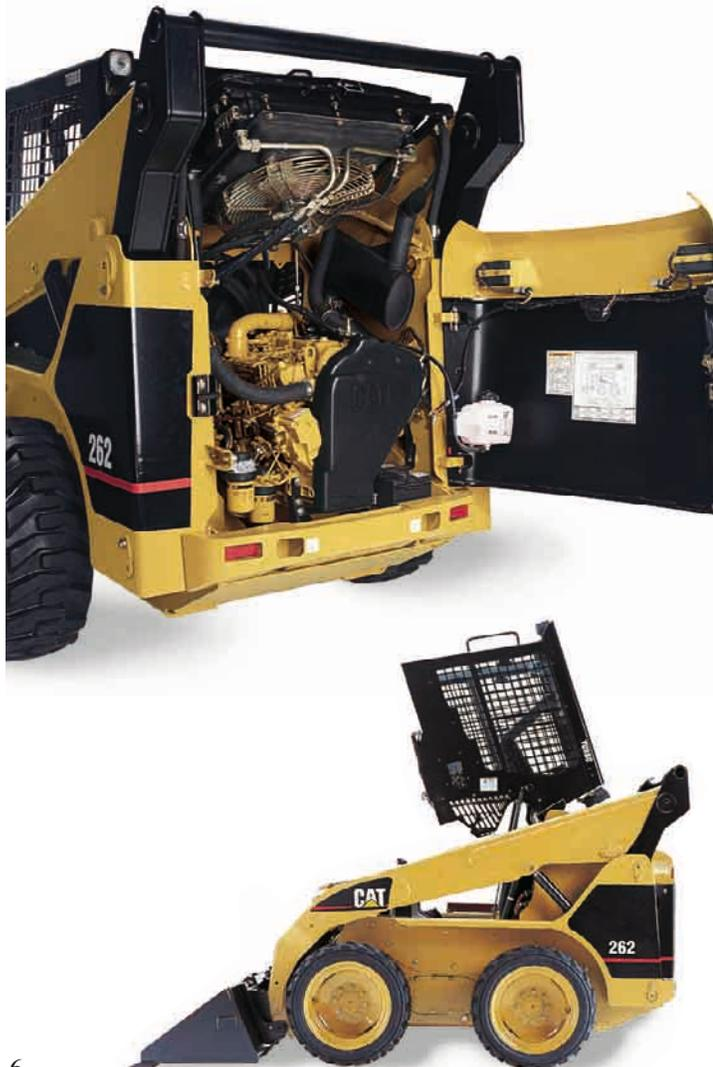
**Instandhaltung.** Bei der Entwicklung der Cat Kompaktlader wurde größter Wert auf guten Zugang zu allen Komponenten gelegt, um den Zeitaufwand für Instandhaltungsarbeiten zu minimieren.
