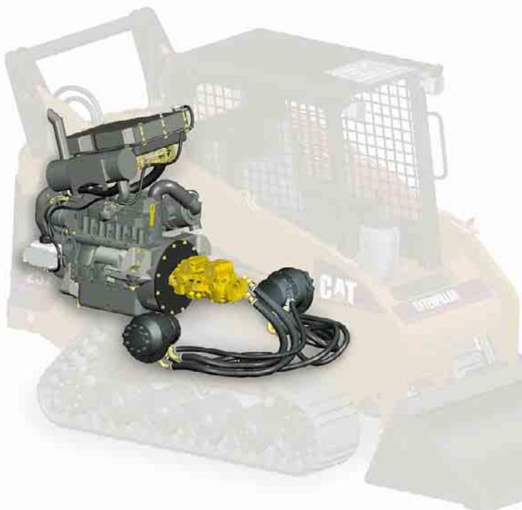
**Dieselmotor.** Der wassergekühlte Caterpillar Vierzylindermotor 3034 mit drei Litern Hubraum entwickelt eine Nennleistung (ISO 9249) von 41 kW im 247 und 44 kW im 257.
