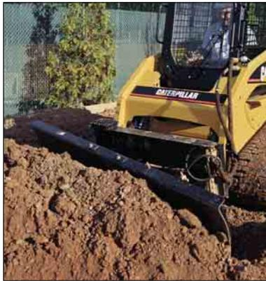
**Konstruktion.** Der Schnellwechsler wurde vollständig in den Hubarm der Deltalader integriert und so konstruiert, dass er weder die Sicht auf das Arbeitsgerät noch das Ein- und Aussteigen behindert.
