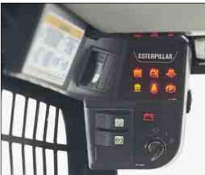
**Linke Schalttafel.** In der linken, oberen Schalttafel sind LED-Kontrollleuchten und Betriebsstundenzähler untergebracht. Abhängig von der Maschinen-ausrüstung befinden sich hier außerdem die Schalter für Motorstart/-stopp, Feststellbremse, Vorglühanlage, Zusatzhydraulik-Dauerbetrieb, Zusatzhydraulik-Abschaltung, Arbeitsgeräte-Stellungsregler und elektrische Stromversorgung (Zusatzverbraucher).
