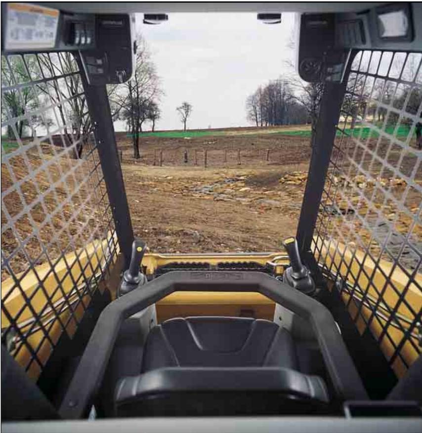
**Fahrerkabine.** Die ergonomisch gestaltete Kabine mit leichtgängigen Steuerhebeln ermöglicht dem Fahrer ein ermüdungsarmes, produktives Arbeiten. Große Frontöffnung, seitlich liegende Kippzylinder, praktische Griffstangen und rutschhemmende Trittstufen machen das Ein- und Aussteigen mühelos und sicher. Um die Instandhaltung zu erleichtern, lässt sich die Kabine nach hinten hochkippen.
