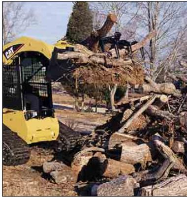
**Mechanischer Schnellwechsler.** Mit der standardmäßigen, manuell verriegelbaren Schnellwechseinrichtung lassen sich die Cat Deltalader-Arbeitsgeräte in kürzester Zeit austauschen. Die besonderen Merkmale des bewährten Schnellwechslers:
