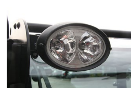
2 x Dual Power Arbeitsscheinwerfer vorne, 1 x Single Power hinten
