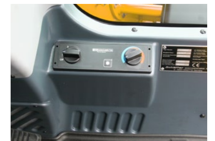
Heizung mit leistungsfähigem, 3-stufigen Gebläse
