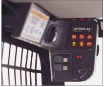
Linke Schalttafel. In der linken, oberen Schalttafel sind LED-Kontroll-leuchten und Betriebsstundenzähler untergebracht. Abhängig von der Maschinenausrüstung befinden sich hier außerdem die Schalter für Motorstart/-stopp, Feststellbremse, Vorglühanlage, Daueraktivierung (Zusatzhydraulik), Sperrfunktions-übersteuerung (Hydraulik), Parallelführung (Hubeinrichtung) und elektrische Stromversorgung (Zusatzgeräte).
