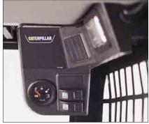
**Rechte Schalttafel.** Die rechte, obere Schalttafel enthält Kraftstoffvorratsanzeige und Innenleuchte sowie Schalter für Arbeitsscheinwerfer und Rundum-Kennleuchte.
