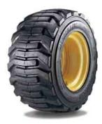
Conventional Flotation. Infolge der großen Aufstandsfläche bestens für Anwendungen auf wenig tragfähigen Böden zu empfehlen.
