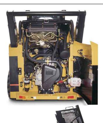
Instandhaltung. Bei der Entwicklung der Cat Kompaktlader wurde größter Wert auf guten Zugang zu allen Komponenten gelegt, um den Zeitaufwand für Instandhaltungsarbeiten zu minimieren. Die wichtigsten Wartungspunkte wurden an gut erreichbaren Stellen in Gruppen zusammengefasst.
