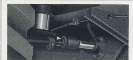
**Direction entièrement hydraulique** permettant des manoeuvres rapides et précises. Braquage de 35° à gauche ou à droite (roues intérieures). Diamètre de braquage sur l'axe de la roue jumelée: 12,4 m/40'8". Vérin de direction intégré au pont AV: entretien plus facile et meilleure protection. Direction de secours assurée par une pompe entraînée par le volant.
