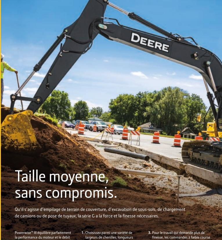
Powerwise™ III équilibre parfaitement la performance du moteur et le débit hydraulique pour un fonctionnement prévisible. Trois modes de productivité permettent de choisir le style d'excavation adapté au travail. *Haute productivité* fournit plus de puissance et une réaction hydraulique plus rapide pour déplacer plus de matière. *Puissance* fournit un équilibre de puissance, rapidité et consommation pour le travail normal. *Économie* réduit la vitesse maximale et aide à ménager le carburant.
