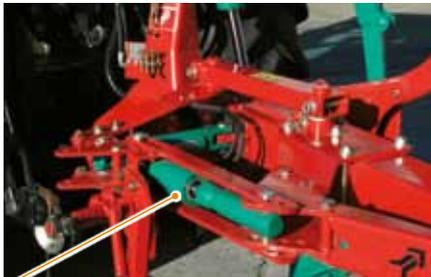
Ajustes hidráulicos (opcionales) de la alineación del primer surco y del chasis (por separado).
