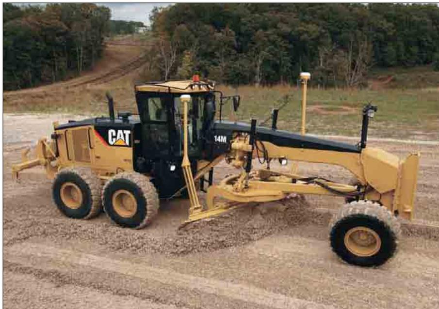
Система AccuGrade™ в 14М
