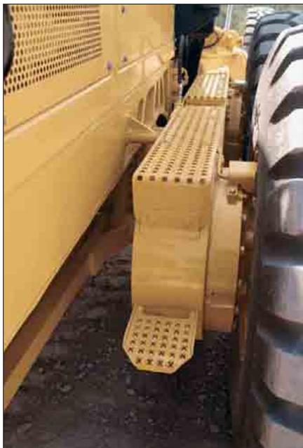
**Стальные мостки над задней тележкой мостов.** Над задней тележкой мостов устанавливаются мостки со стальным перфорированным настилом. На них удобно и безопасно стоять и ходить, и помимо этого они защищают тормозные шланги.
