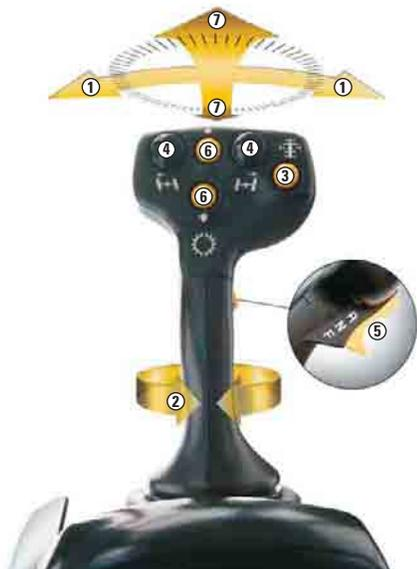
**Функции левого джойстика.** Основное предназначение левого джойстика — управление направлением движения машины и скоростью.
