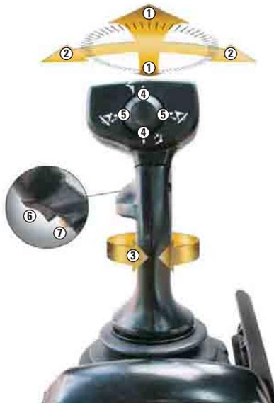
**Функции правого джойстика.** Основное предназначение правого джойстика — управление тяговой рамой, поворотным кругом и отвалом.
