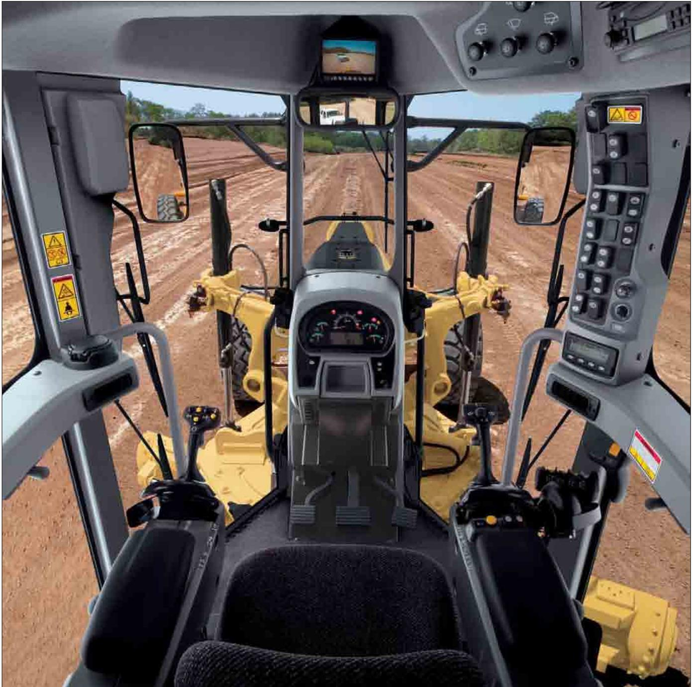
**Усовершенствованное управление джойстиком.** Управление двумя электромеханическими джойстиком требует меньше усилий: оператор совершает на 22% меньше движений руками по сравнению с обычным управлением рычагами, благодаря чему повышается производительность труда. Схема работы джойстиков проста и понятна. Она обеспечивает высокую точность управления орудиями, свойственную всем машинам Caterpillar.
