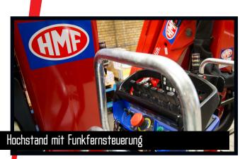
Mit einem Hochstand und Funkfernsteuerung hat der Kranbediener einen hervorragenden Überblick über die Kranbewegungen. Der Funksender der Funkfernsteuerung ist in einem Halter auf dem Hochstand angebracht. Die HSL- und HSL-E Systeme verhindern, dass der Kran den Kranbediener am Hochstand trifft und schützen somit den Kranbediener.
