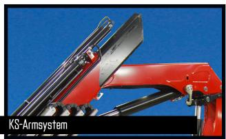
Das KS-Armsystem ist mit einem kürzeren Knickarm ausgerüstet als ein Standard Knickarmsystem. Mit einem ausgefahrenen KS-Armsystem lässt sich der Kran in eine 4 Meter lange Pritsche ablegen, ohne dass der Zweischalengreifer abmontiert werden muss. Die Hubhöhe neben der Säule ist über 3 m. Dies ermöglicht Hübe von hohen Lasten neben der Säule. Das Armsystem ist mit 1, 2 oder 3 hydraulischen Ausschüben erhältlich.
