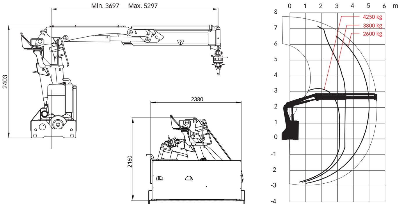
**Vorbehaltserklärung:** Hiab-Krane werden entsprechend höchster Standards für Sicherheit und Haltbarkeit hergestellt und sorgfältig getestet. Festigkeitsberechnungen für dieses Modell erfolgten entsprechend EN 13001 in Ermüdungsklasse S2.
