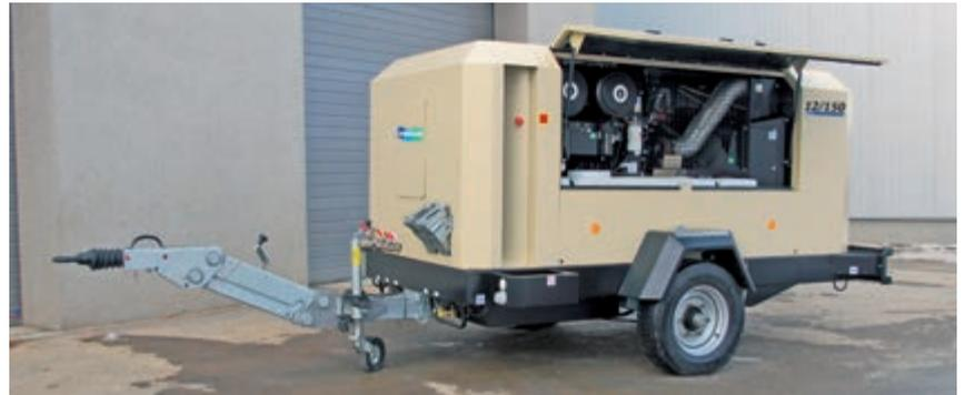
Les portes à large ouverture et les bouchons de vidange extérieurs regroupés assurent un entretien facile et rapide du compresseur 12/150, tout comme les zones d'accès soigneusement conçues pour faciliter les opérations d'inspection, de maintenance et de réparation.
