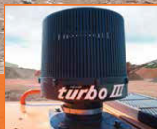
System wstępnego oczyszczania powietrza Turbo III działający na zasadzie siły odśrodkowej
