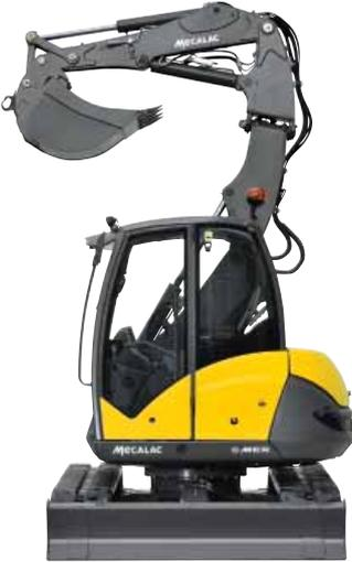
Bei den Modellen 8MCR und 10MCR handelt es sich um wendige und effiziente Multifunktionsmaschinen sowohl zum Baggern (Ausheben, Verfüllen) als auch zum Laden (Auf-, Ab-, Verladen und Befördern) von Paletten oder Materialien.
