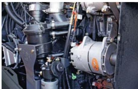
Se puede acceder fácilmente a los puntos de servicio del filtro de combustible y del aceite del motor desde ambos lados de la máquina. Los otros filtros se encuentran en la parte trasera de la escalera derecha.
