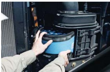
Se puede retirar fácilmente el filtro de aire, y el polvo se aspira y se expulsa con los gases de escape.
