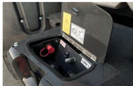
Interruptor de apertura del capó y de encendido/apagado de la batería. El capó puede abrirse externamente con arranque remoto si la batería se descarga.
