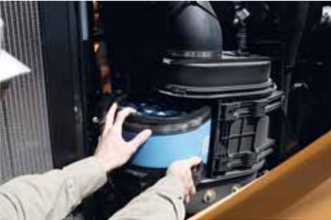
*El filtro de aire se desmonta fácilmente y el polvo se aspira y se expulsa por el sistema de escape.*
