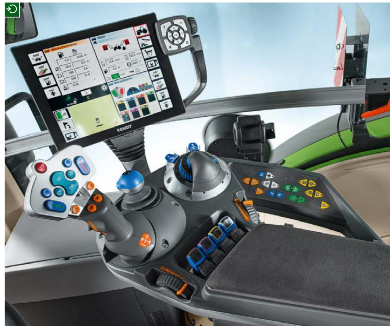
L'intero sistema di comando sul bracciolo destro, composto da un terminale Vario 4 in 1, un joystick multifunzione, una leva a croce, modulo sollevatore EHR, comando delle valvole e tastiera a membrana, è l'unità di comando centrale ergonomica dell'operatore per avere tutto a portata di mano.
