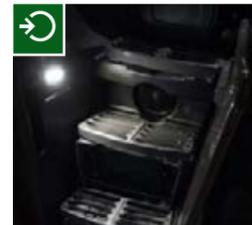
Le luci guida integrate per l'accesso alla macchina posizionate lateralmente al serbatoio garantiscono una salita e una discesa dal mezzo in tutta sicurezza anche al buio.
