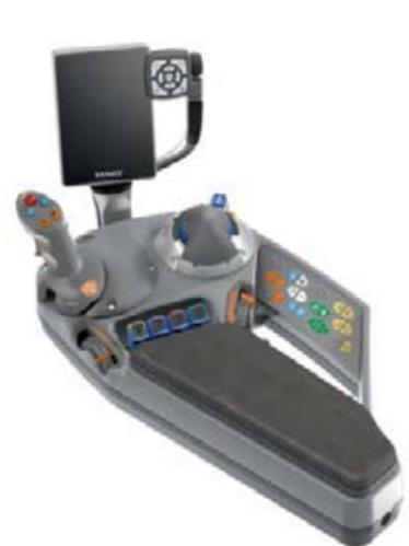
Il bracciolo multifunzione con equipaggiamento Power con Varioterminal 7-B; joystick Power con gestione in capezzagna Variotronic<sup>21</sup> tasti tempomat e giri del motore; modulo di comando EHR per sollevatore posteriore e anteriore; Varioterminal 7-B con look a smartphone e superficie in vero vetro per una visione eccellente di tutte le funzioni, un menu intuitivo, comandi touch e con tasti e controllo attrezzi ISOBUS.
