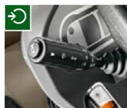
Come ogni Fendt, anche il Fendt 1000 Vario facilita il lavoro quotidiano grazie a piccoli e pratici dettagli funzionali come il reset automatico delle frecce: la freccia del trattore lampeggia fino al completamento della sterzata.
