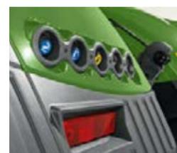
Grazie al comando esterno a valvola è possibile attivare il sollevatore posteriore, una valvola e la presa di forza direttamente sul parafrangente posteriore.
