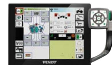
La gestione attrezzi Variotronic consente di comandare attrezzi ISOBUS direttamente con il joystick o il terminale Vario.
