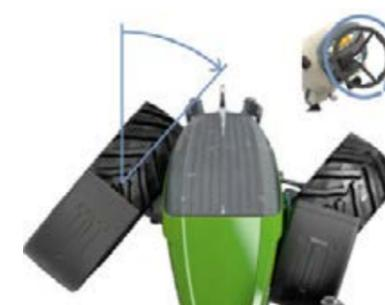
VarioActive consente di ottenere un angolo di sterzata completo già con un solo giro dello sterzo.
