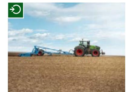
Grazie al sistema di gestione del trattore TMS e al limitatore del calo di giri 2.0, il trattore adatta il regime del motore in modo ottimale in base alla velocità di marcia.
