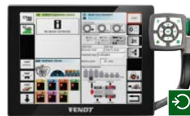
Con la scelta della velocità, il Grip Assistant suggerisce la giusta pressione degli pneumatici, nonché il corretto zavorramento. Con la scelta dello zavorramento, l'assistente suggerisce la corretta velocità di lavoro e la pressione degli pneumatici.
