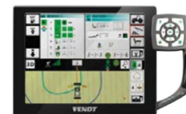
La gestione per capezzagna Variotronic<sup>1</sup> salva tutte le sequenze di cambio. Variotronic<sup>1</sup> automatic attiva automaticamente le sequenze esattamente nel punto giusto.
